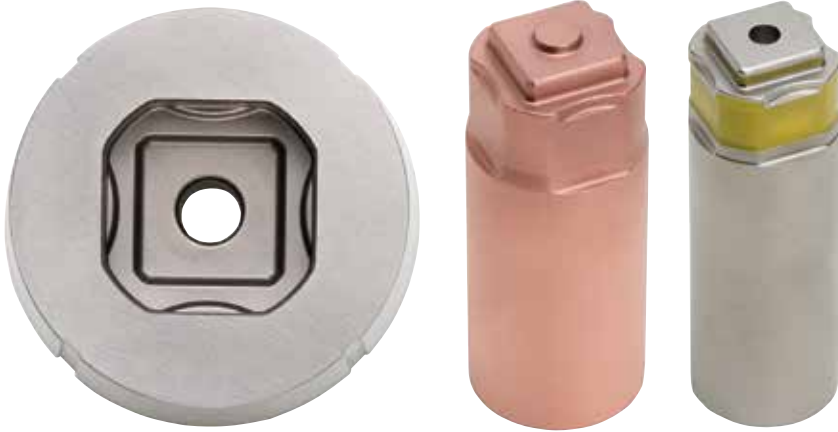
3 Anfangs wurde bei WTN die linke Automotive-Formmatrize (PM-Stahl, Losgröße 30, Maßtoleranz \pm 0,02 mm, Rundlauf < 0,01 mm, Oberflächengüte R_a 0,15 \mu\text{m} ) erodiert, jetzt wird sie »gepemmt«. Statt mit EDM 18 Kupferelektroden (Mitte) je Los und 165 min Bearbeitungszeit je Bauteil benötigt WTN jetzt nur noch eine verschleißfreie PECM-Elektrode (rechts) und nur 42 min je Teil. Die Zeit für das Finishing sank von 35 auf 3 min (Bild: WTN)
