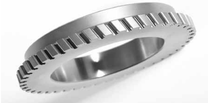
4 Diese hochpräzise Turbinenscheibe aus Inconel, in die später Schaufeln eingefügt werden, steht beispielhaft für Komponenten der Luft- und Raumfahrt, die mittels PECM so wirtschaftlich wie mit keinem anderen Verfahren gefertigt werden können (Bild: PEMTec)
